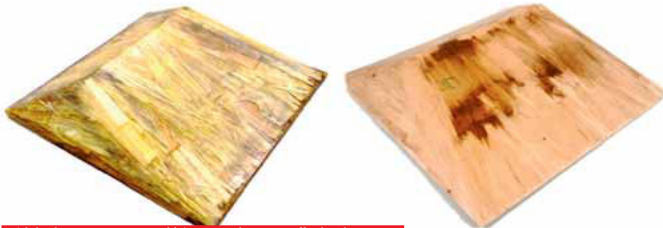
Leichtbaukomponenten aus Hochleistungs-Holz-Kunststoffverbunden (HHKV) mit lastpfadgerechter Ausrichtung von Langholzspänen
