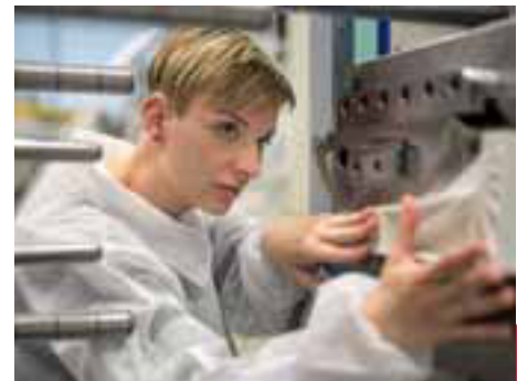
Eine Werkzeugmechanikerin spannt ein Werkzeug in die Maschine ein.
