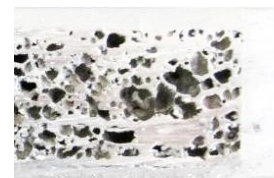
Aluminiumschaum mit Thermoplast umspritzt
