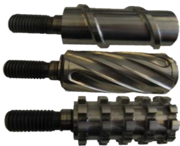
Förder-, Scher- und Mischelemente des Schneckenbaukastens
