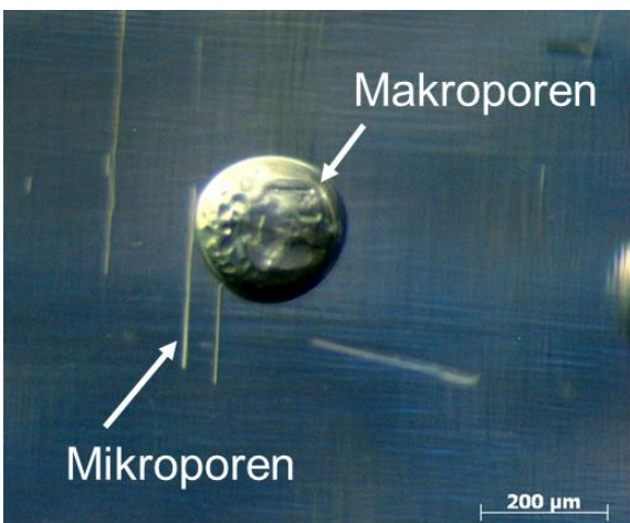
Abbildung 1: Durch ungleichmäßiges Fließen entstandene Fehlstellen
