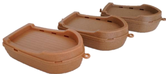
Abb. 2 - Spielzeugboote aus NFK (Polypropylen und 20 % Holzspäne). Vorne: Neuwertiges NFK-Produkt, Mitte: 15 % Regranulatanteil, Hinten: Produkt aus Regranulat
