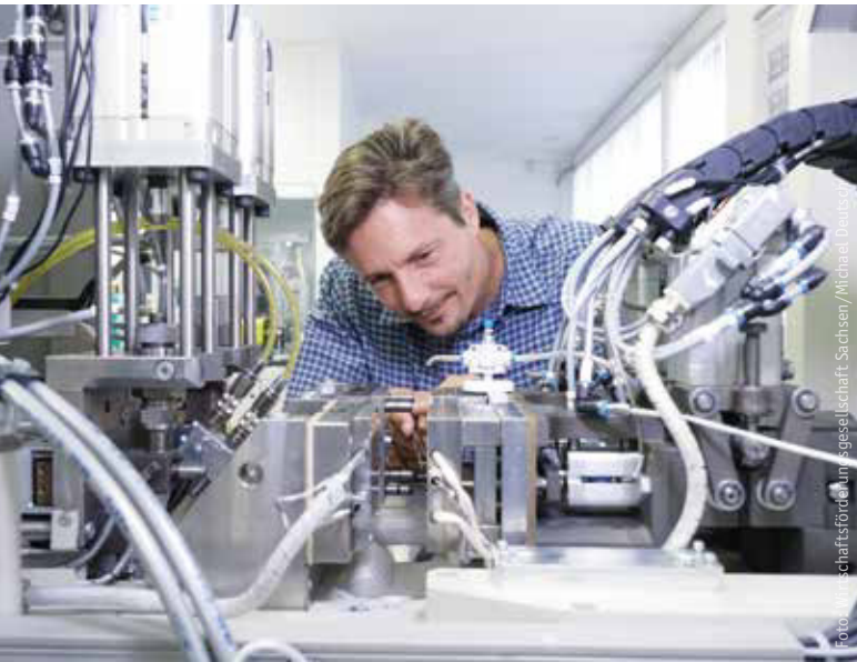
Dr. Gabor Jüttner an einer 2K-Spritzgießmaschine im Applikationszentrum für Mikrokunststofftechnologien (MikA) des KUZ.
