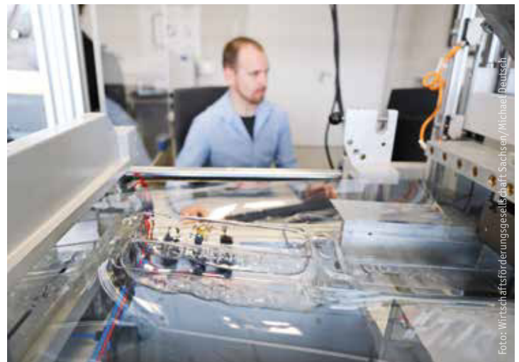
Andreas Kunze von Wattron entwickelt Strategien zum segmentierten Aufheizen mit dem Ziel optimaler Wanddicken beim Thermoformen.
