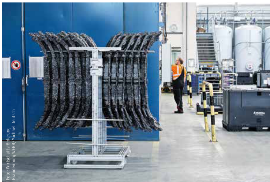
Proseat stellt in Schwarzheide leichte Partikelschaumteile aus expandierbarem Polypropylen (EPP) für Automobilanwendungen her.
